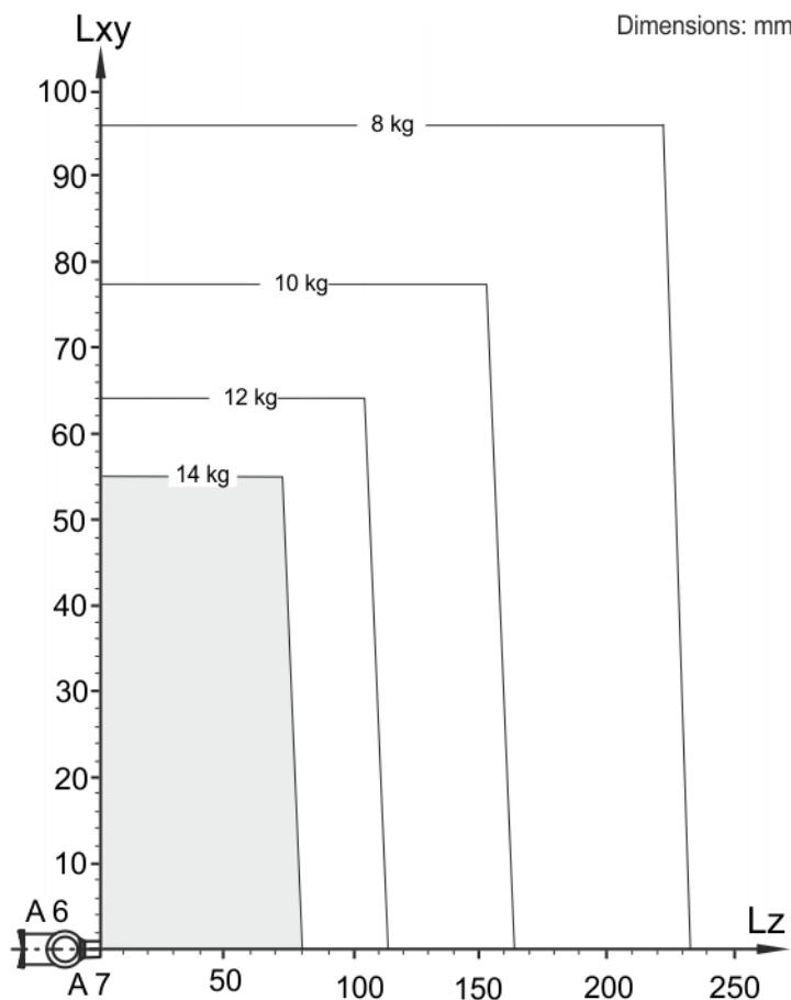
**Fig. 4-66: LBR iiwa 14 R820 payload diagram**
