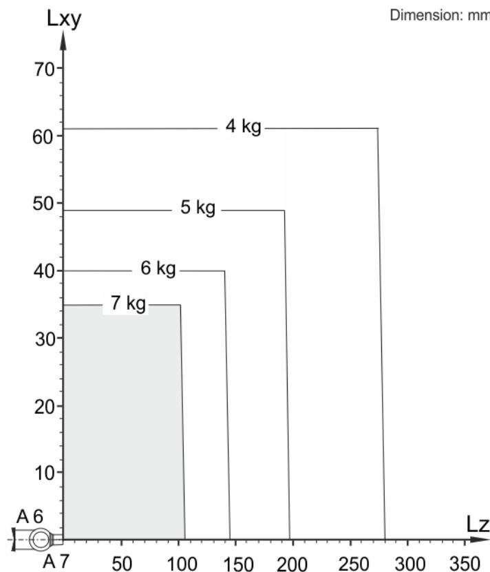
**Fig. 4-14: LBR iiwa 7 R800 payload diagram**
