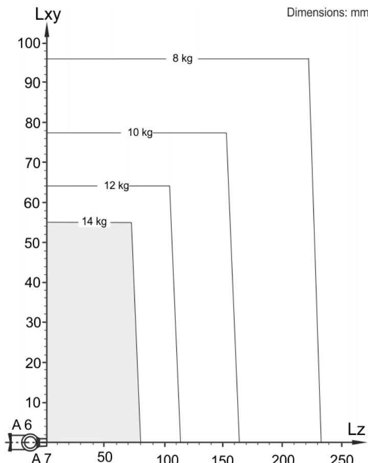
**Fig. 4-16: LBR iiwa 14 R820 payload diagram**
