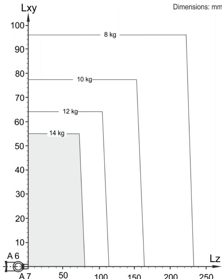
**Fig. 4-36: LBR iiwa 14 R820 payload diagram**
