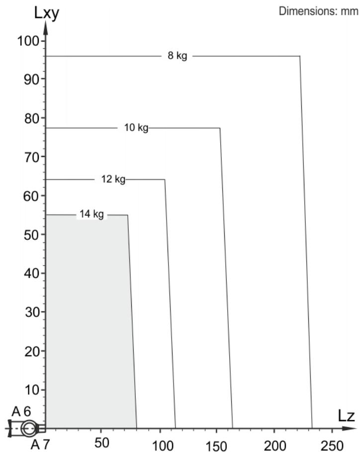
**Fig. 4-96: LBR iiwa 14 R820 payload diagram**
