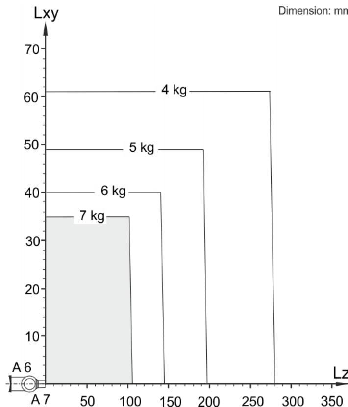
**Fig. 4-94: LBR iiwa 7 R800 payload diagram**
