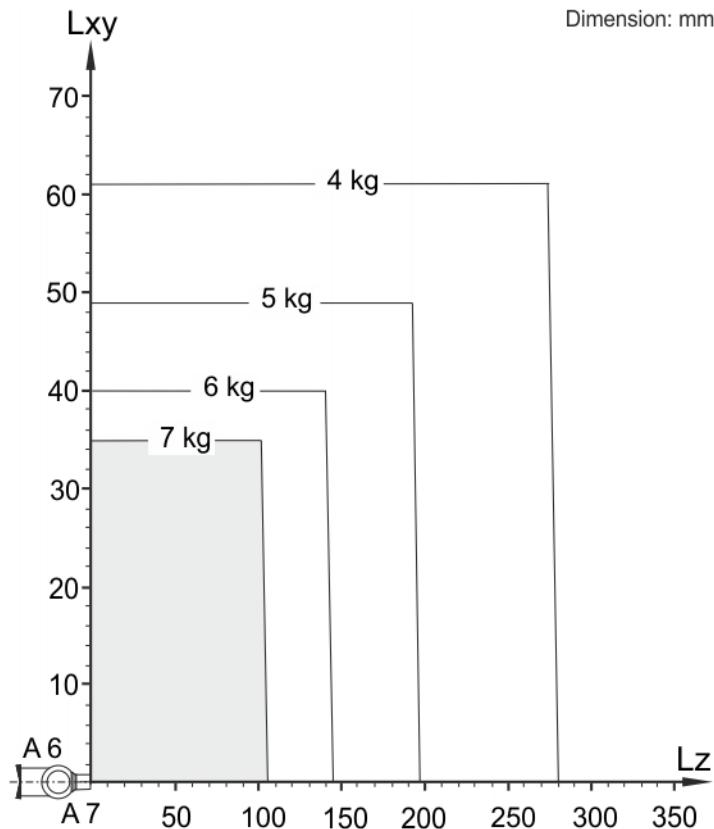
**Fig. 4-64: LBR iiwa 7 R800 payload diagram**
