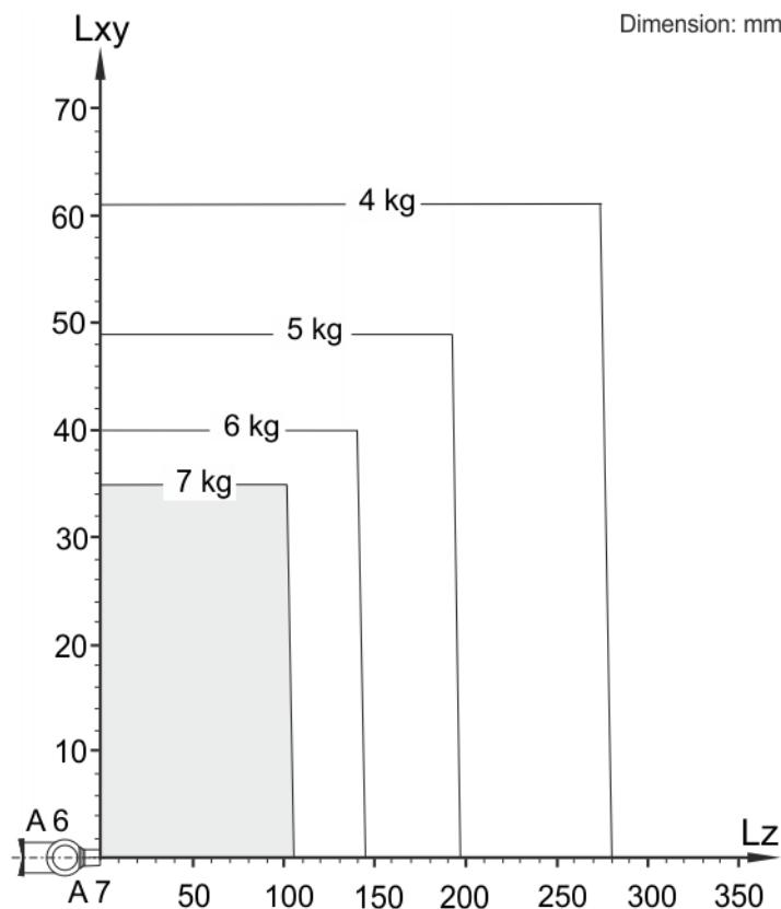
**Fig. 4-4: LBR iiwa 7 R800 payload diagram**
